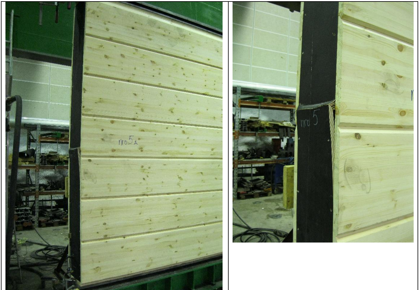
Kuva 9 Vanerisen karapuun vaurio epäkeskisessä kuormituksessa
