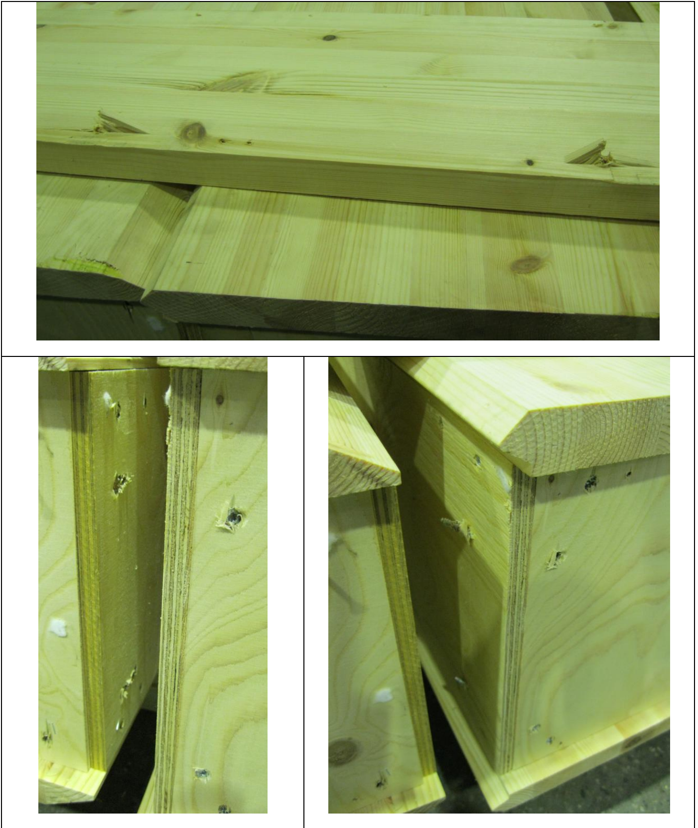
Kuva 13 Karapuun läpäisseiden ruuvien reikiä, hirsien välisen vinoruuvauksen ruuvien ulosvetomurto
